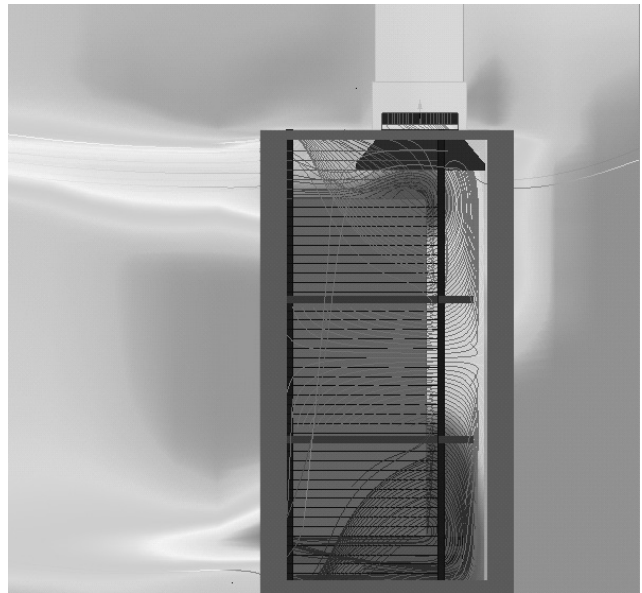
▼図1 石狩データセンターでのVPSサーバラックの温度分布(上方に排気されている)
