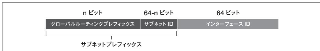
IPv6のアドレス自動設定には、SLAAC(ステートレスアドレス自動設定)と呼ばれるNDP(近隣探索プロトコル)のRA(ルータ広告)と自ホストで生成するインターフェースIDを組み合わせて設定するものや、IPv6版のDHCP(DHCPv6)を使うものなどいくつかの方法があります(表4)。
