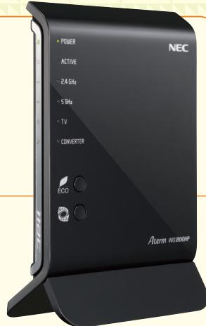
無線 LAN の新規格「Draft IEEE802.11ac」に対応した Wi-Fi ホームルータ。5GHz 帯で最大 1,300Mbps の高速 Wi-Fi 通信が可能。また世界最小クラスのアンテナ「μ SR アンテナ」を採用することで、Draft 11ac 対応でありながら従来機と同等のコンパクトデザインを実現しています。
