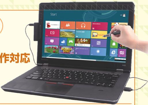
タッチパネルに対応していない PC をタッチ操作可能にするデジタルペン。ベースユニットと呼ばれる機器を PC に取り付け、赤外線と超音波でタッチ位置を検出。ペンを使ってタブレットのようなタッチ操作ができるようになります。対応 OS は Windows 7/8、17 インチ以下のディスプレイで使用可能です。※製品に PC は付属しません
