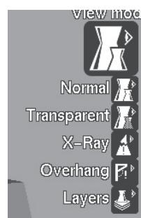
す(図10)。「Normal」は通常のモデルイメージの表示、「Transparent」は透過表示、「X-Ray」は3Dモデル的に問題(不整合)がある個所を色つけ表示、「Overhang」はオーバーハング部分を色つけしてサポート材が必要かどうか確かめられる表示(図11)、「Layers」は積層モデルで見たい高さの断面がどうなっているか、を確認できる表示です。モデルをプリントする前に不具合を確認できますので、とても便利な機能だと思います。
