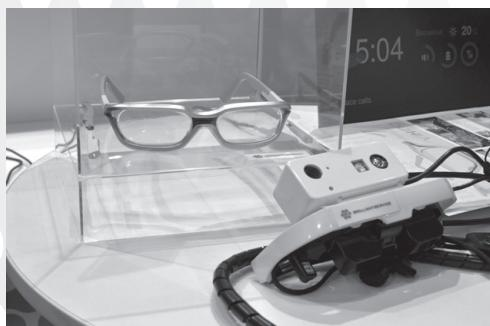
▼写真5 カメラとヘッドマウントディスプレイが一体化
