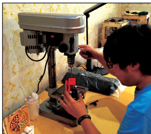
▼写真5 ボール盤で3Dプリンタの部品に穴を開ける筆者
