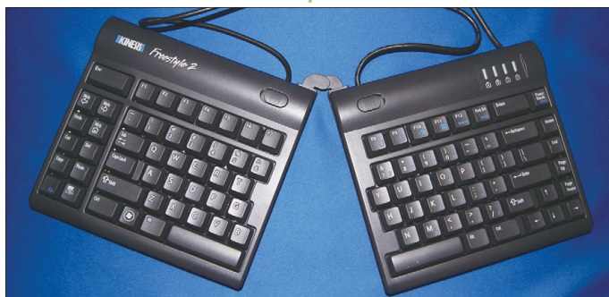
写真2 左右のパーツをフックでつなげる
