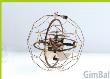
「Gimbal」障害物や廃墟の中でも安定して飛行できるボール型のガードつきドローン http://lis.epfl.ch/gimbal
