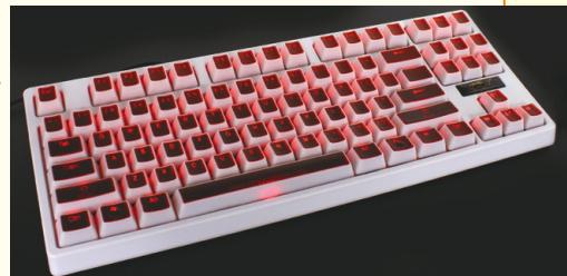
キーの内側から LED が発光するメカニカルタッチの cherryMX 青軸キーボードです。キー配列は 87 キー英語配列、インターフェースは USB です。LED は [Fn] + [↑] で明るくなり、[Fn] + [↓] で暗くなり消灯します。ラインナップは、赤いキートップにレッド LED のモデルと、青いキートップにグリーン LED のモデルの 2 種類です。各カラー 1 名様ずつプレゼントします。
