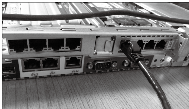
▼写真1 1000BASE-Tのポートが10個搭載された NEC Express5800/R120d-1M
