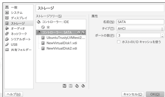
図2 SATAに3つのHDDをぶら下げる
