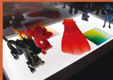
⤴ Stratasys Objet500 Connex3で出力したグラデーションのあるカラフルなオブジェクト
