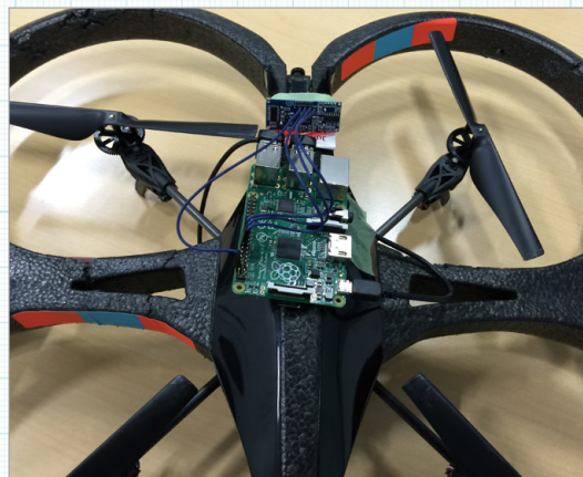
▼ 写真2 ラズパイを搭載したドローン
