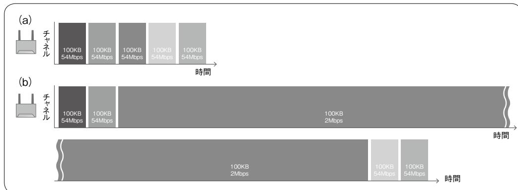
ように5台の端末が100KBずつ同じ54Mbpsのデータレートで計500KB転送することを考えます。どの端末も同じ時間で転送が終了しました(めでたしめでたし)。ところが、次にまた同じデータを転送しようとしたら、特定の端末が遠くへ行ってしまったために通信状況が悪化し、データレートが2Mbpsに下がりました。同じく100KBずつ転送を行います(図5)。
