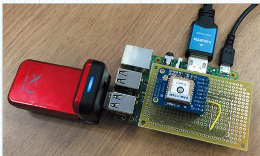
回路といつても複雑なことはなく、GPSモジュールに電源を供給し、シリアルの出力(TX)をRaspberry PiのUART0\_RXDにつなぐだけです。ただし、そのままでは(ノイズが多いからか)測位ができなかったので、5V-GND間に0.1μFのパスコンと、電解コンデンサを接続して対策しました。
