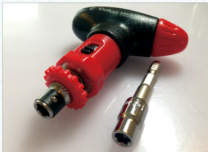
▼写真2 E-Value T型ラチェットドライバーセット「ERD-3」
