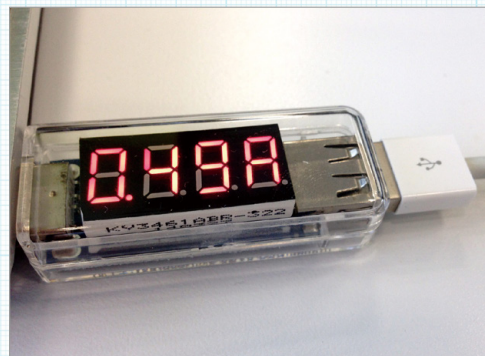
▼写真8 USB簡易電圧・電流チェッカー
