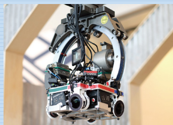
超高解像度のデジタルビデオカメラ4台を 搭載した、パノラマ撮影用カメラセット
