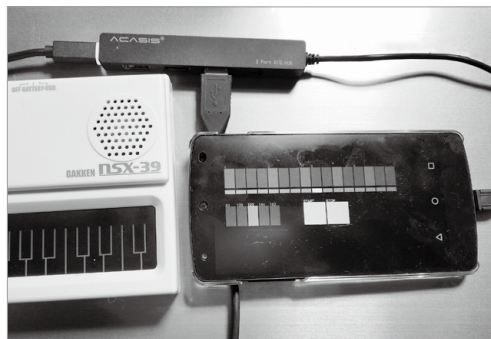
▼写真2 USB OTG Hubを介して実験用に機材を接続
