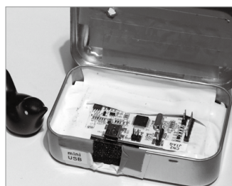
▼ 写真3 STM32 Nucleo のデバッグ部を使った NeuG の実装例 [20]
