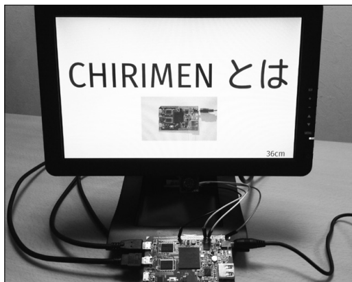
▼写真3 サマリ画面：画面右下に36cmと出ているのは距離センサの値を示している
