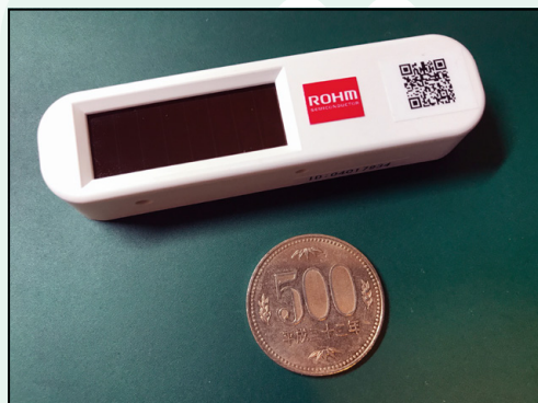
▼写真2 温度センサモジュールと温度センサモジュールを樹脂ケースに納めたもの
