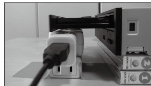
光学ドライブの調整が済んだら、電源ケーブルを配線し、USB変換ケーブルで光学ドライブとRaspberry Piとをつなぎ合わせます。
