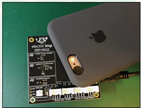
します。次に、impExplorerがネットワークに接続している間、LEDは赤とオレンジと交互に点滅します。接続が成功すると、LEDは緑色のゆっくりとした点滅をします。impExplorerがimpCloudと接続できると、IDEの「Devices」という画面にBlinkUpしたimpExplorerが追加されます(図3)。
