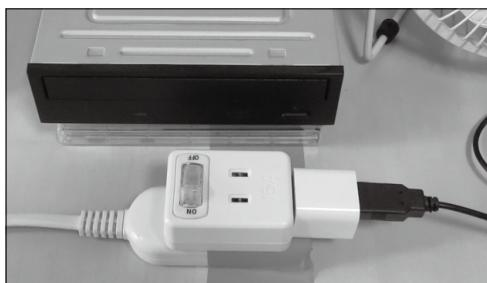
いろいろなものを置いて試してみてください。今回はアニメのブルーレイディスクケース2枚がちょうどよい高さになりました。物理的な工作はこれで完成です(写真4)。設置できたら手でEjectさせてみて、トレイがスイッチをオン・オフすることを確認します(写真5、写真6)。
